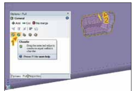
Рис. 32. Создание фаски на внешней границе выреза под разъем
